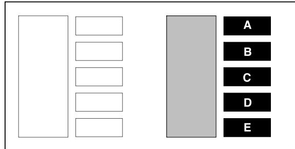
Tastaturen mit 5 Tasten für jede Brühgruppe (max. 4) und 5 Anzeigelampen, die sich wie folgt zusammensetzen:
