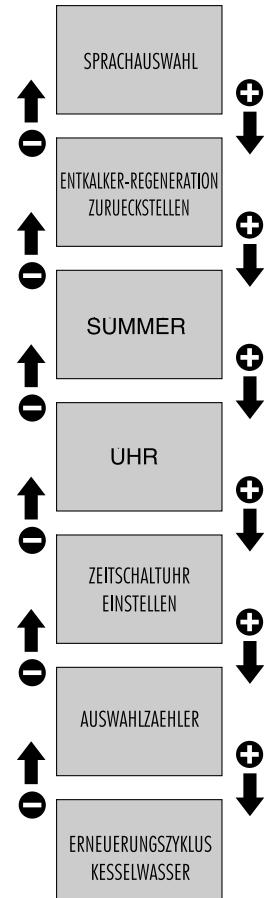
Um von einem Menü zum anderen gelangen, die Tasten "+" oder "-", drücken; um in ein Menü zu gelangen, die Taste "enter" drücken und um es zu verlassen "esc" drücken.
