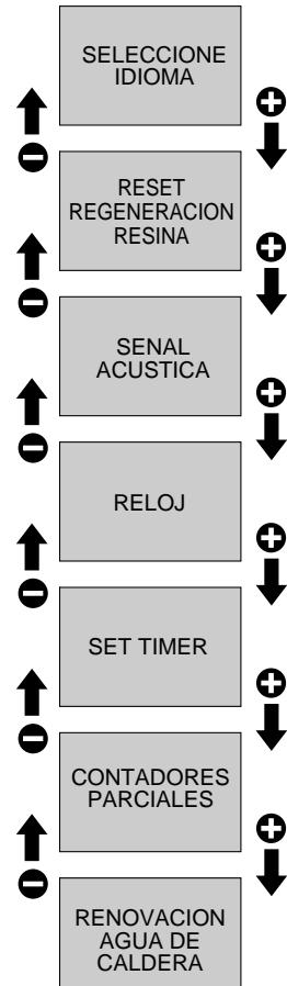
Para desplazarse de un submenú a otro presionar “+” o “-”, para entrar en un submenú presionar “enter”, mientras que para salir presionar “esc”.
