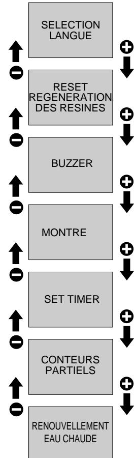
Pour passer d'un sous-menu à un autre appuyer sur "+" ou "-"; pour entrer dans un sous-menu appuyer sur 'enter' et appuyer sur 'esc' pour en sortir.
